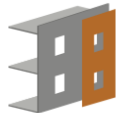
Façade ossature bois sur paroi pleine (FOB_P)
